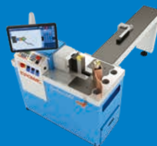
Plegadora eléctrica automatizada
