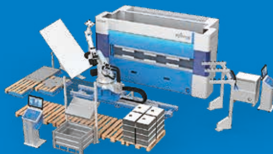
Plegadora eléctrica automatizada
