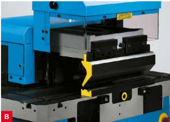
B Abkantwerkzeug entlastet Ihre Abkantpresse: biegt bis 415 mm lang und bis 5 mm dick.
