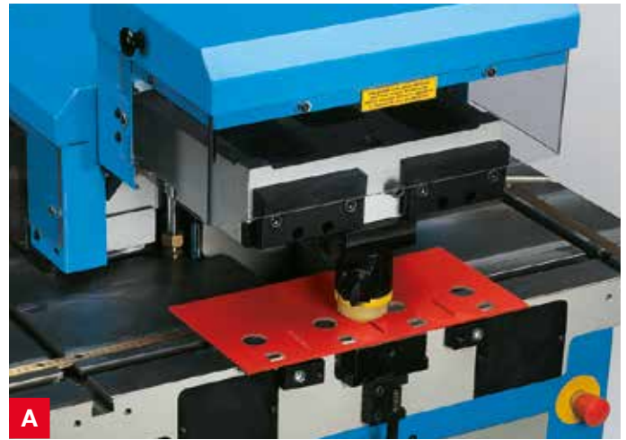
A Halter für Stanzwerkzeug für Trumpf Werkzeuge bis 50 mm Durchmesser ( rund, vierkant, Formlöcher).
