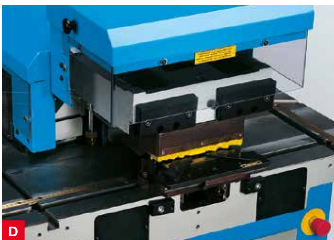
D Einheit zum Radienrunden für Radien von 3 bis 15 mm in Blech bis 6 mm.
