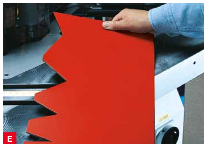
E Ausklinken mit variablem Winkel auf VA-Modelle stufenlos von 30° bis 140°.
